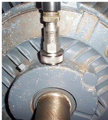
图#1 – 测量外壳振动
