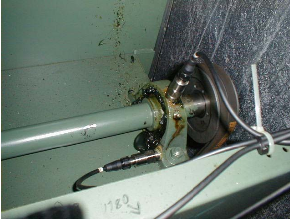
用回流电源传感器监测轴承的振动值
