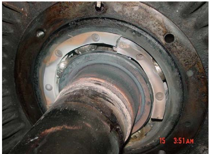
失效的电机轴承 别让这发生在你的设备上!
