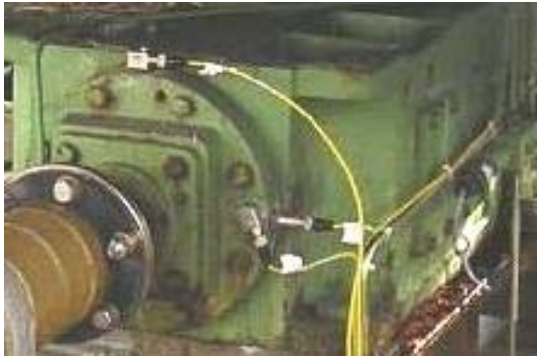
齿轮箱上的加速度传感器
