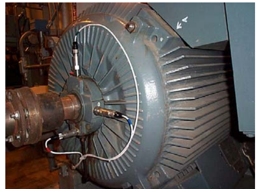
检测电机轴承的振动状态
