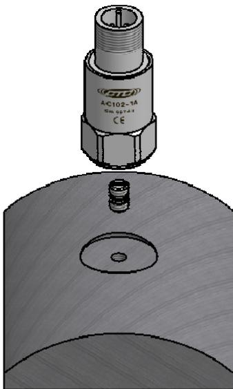
在加工过的平面上安装振动传感器
